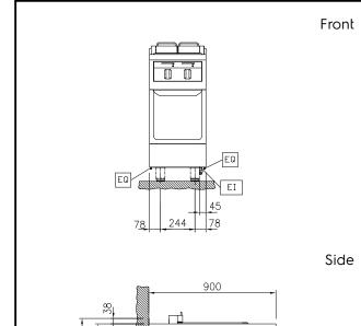
Electrical inlet (power) Equipotential screw
